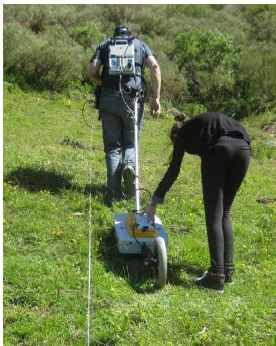
Fig.2. Medición mediante Georrádar de uno de los perfiles en zona A, a lo largo de la máxima pendiente. Pueden verse, en la zona superior, las estacas clavadas en el terreno. El avance se produce a lo largo de un hilo, para mantener la orientación.
