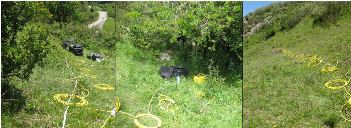
Fig.3. Perfiles en la zona B (prado inferior). Obsérvense algunos de los electrodos clavados y el cable y la unidad de procesado resistivo en amarillo.
